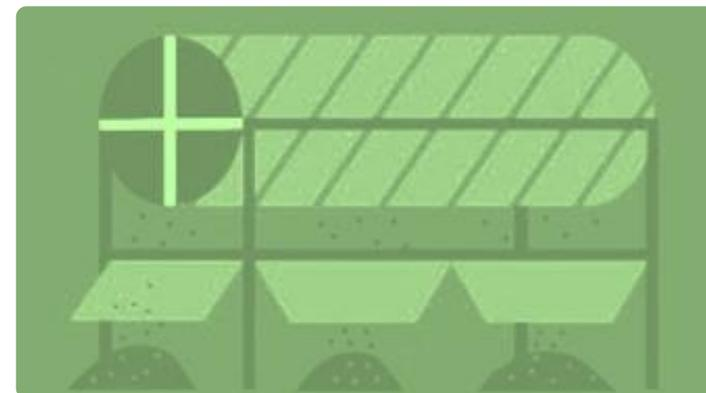
3 Сепаратор барабанного типа
