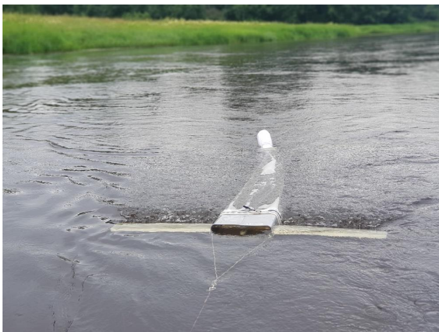
Рис. 1. Отбор проб на микропластик с помощью сети MANTA300 (фото М. Платонова)
